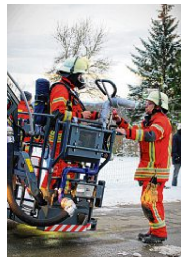
Hier saß jeder Handgriff: Das Wendrohr wird an der Drehleiter montiert. Der Feuerwehrmann im Korb trägt vorschriftsmäßig Atemschutz-Ausrüstung.
