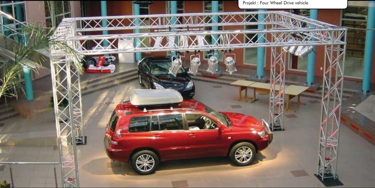
Die X30-Traverse besteht aus 51 x 2mm Hauptrohren und 16 x 2mm Diagonalen, als Verbindung dient das CCS6-System. Prolyte liefert eine Palette an X30- Traversenelementen, die ein
